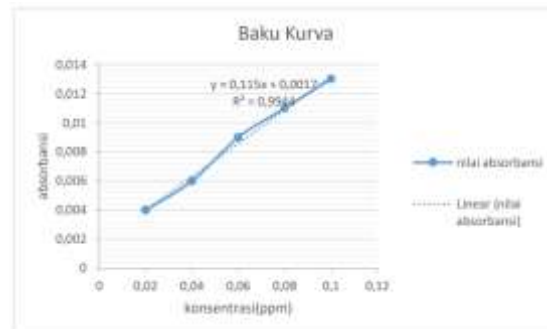
Gambar 2. kurva hubungan antara konsentrasi larutan hidrokuinon standart dengan serapan
